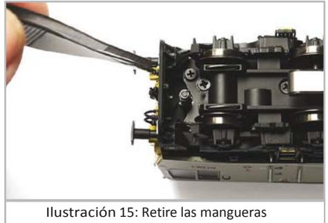
Ilustración 15: Retire las mangueras
