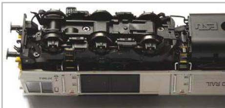
Ilustración 12: Reposición de la carrocería del bogie
