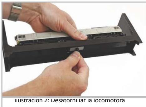
Ilustración 2: Desatornillar la locomotora
