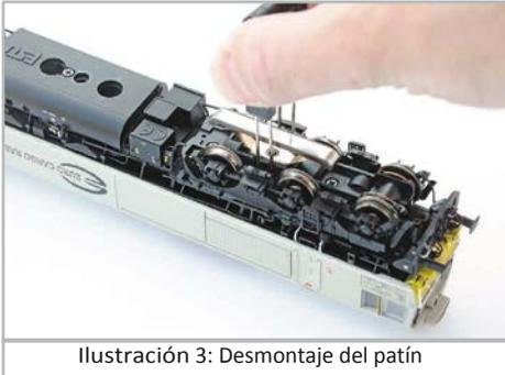
Ilustración 3: Desmontaje del patín
