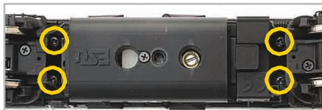
Ilustración 7: Emplazamiento fijación carrocería
