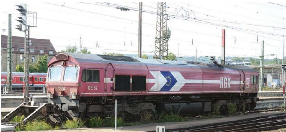
Contrariamente a la DE61, la DE 62 de HGK aún está equipada con un bloque óptico británico con pilotos de posición en el borde exterior.
